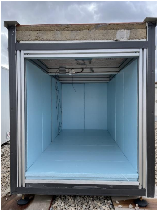
Ilustración 25. Incorporación de aislamiento adicional en los prototipos
