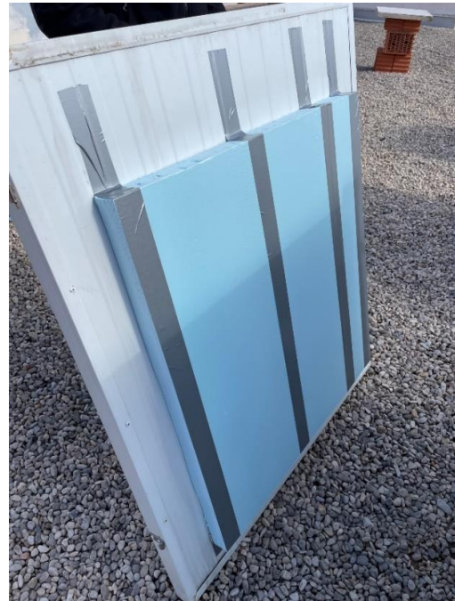
Ilustración 25. Incorporación de aislamiento adicional en los prototipos
